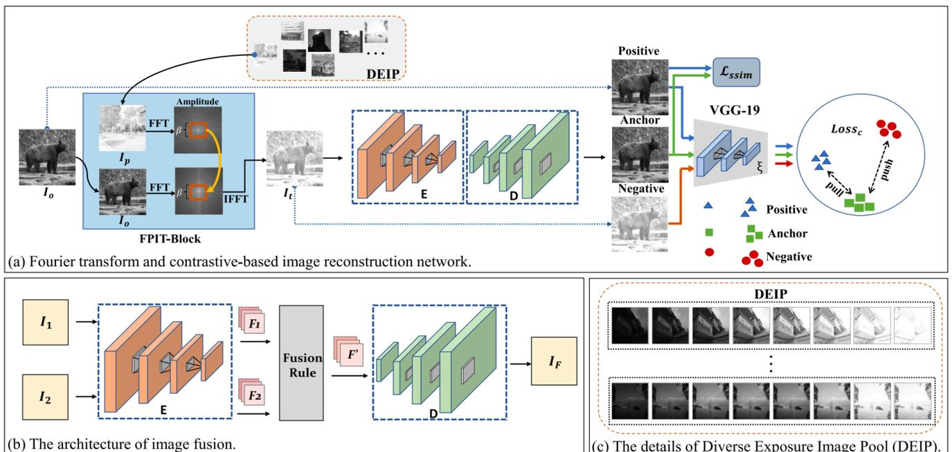
文章利用自然图像数据集和具有多种曝光度图像的数据集构成网络的数据集，克服数据集不足的问题。利用基于傅立叶变换的像素强度转换策略实现在保留图像内容的同时改变其曝光度。
