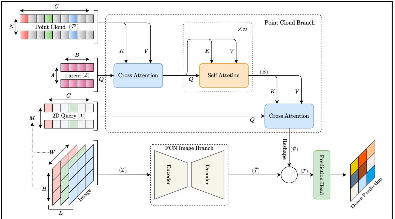
该方法可以忽略空间稀疏性和变量点密度，对每个样本的点数量没有理论限制，作为端到端可学习的方法可以实现3维到2维特征空间的无缝映射。
