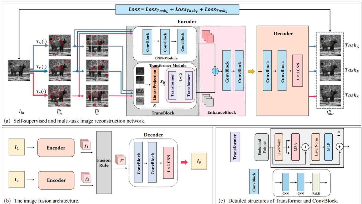
利用 **Gamma-based Transformation**, **Fourier-based Transformation**和**Global Region Shuffling** 生成三种任务。利用CNN block 和Transformer block分别提取信息并合成。最后解码得到输出，根据输出生成loss。
