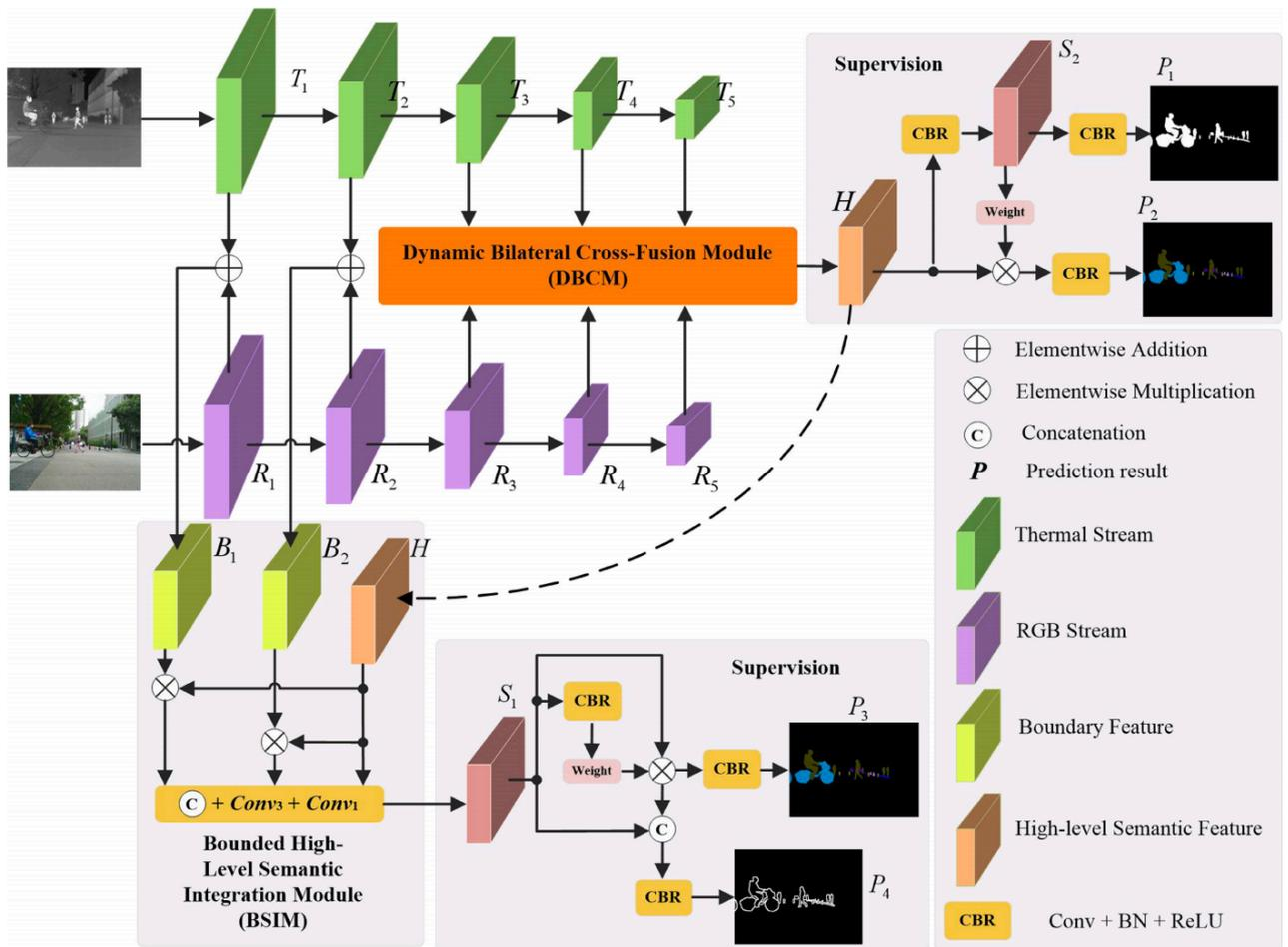
在两个模态的编码过程中，逐步进行特征融合。其中，信息增强模块(IEM)利用多种扩张卷积拼接的方式获取更多信息。由于在encoding过程中，各步骤的feature map 大小不一致，作者提出了动态交叉融合模块对特征进行融合。
