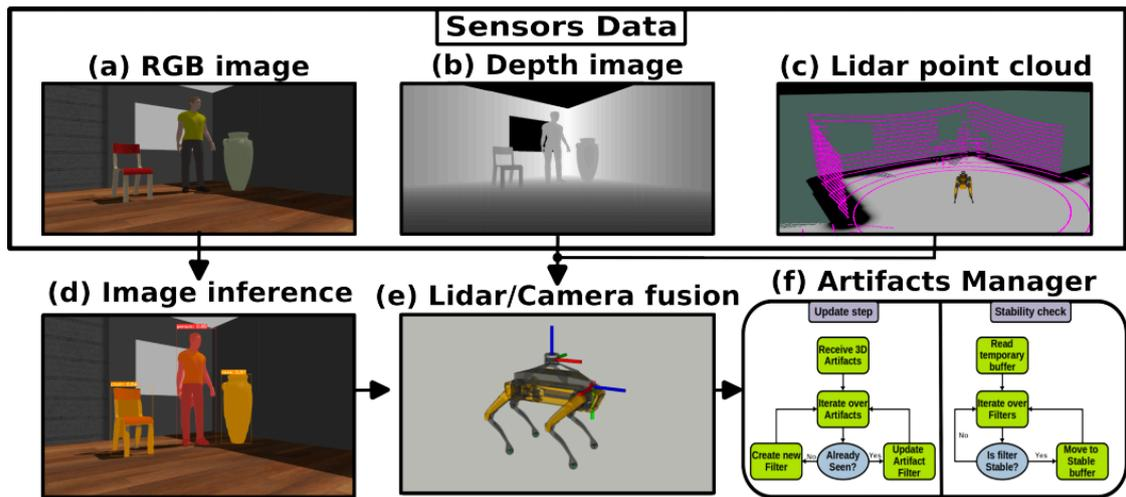
为了实现artifacts管理，算法分别进行位置过滤和位姿稳定。算法维护一个artifacts的临时buffer，当接收到artifacts时，算法检查该artifacts是否在buffer中存在，如果存在则更新buffer，如果不存在则在buffer中创建一个新实例。在位置稳定阶段，算法维护一个stable buffer，如果artifacts可以保持稳定，则会被移入stable buffer中。最后，属于同一个类的artifacts会重叠融合。
