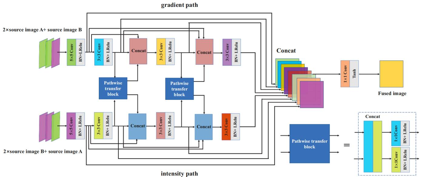
该网络结构包含两条信息提取路径，gradient途径包含了texture information，intensity途径包含了intensity information。在每个输入中，都包含在channel上的两种图像的拼接。
