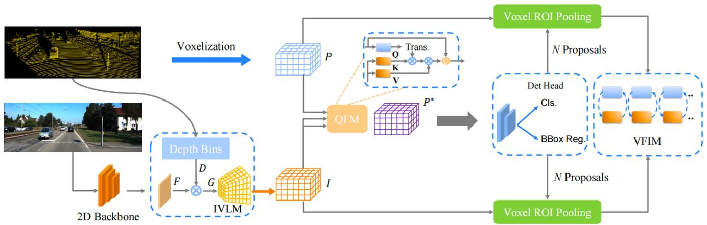
在VFIM中，算法先在3D detection proposal中取样，然后利用voxel RoI pooling分别提取point voxel 和image voxel的RoI 特征。提取出来的特征经过encoder和mlp后，计算cosine similarity并用于优化模型。
